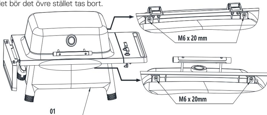
Vinkla anordningen en aning bakåt och ta bort båda M6x20mm skruvarna och gör sedan samma sak på framsidan, stötta delarna så de inte ramlar. Förvara alla fästena för senare användning. Avtagbara klistermärken på framsidan och baksidan markerar positioner för dessa skruvar.
