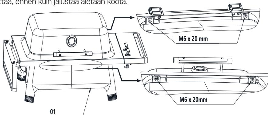
Kallista yhdistelmää hiukan taaksepäin ja irrota molemmat M6x20 mm pultit, toista sitten tämä etuosalle, tue osia niin että ne eivät pääse putoamaan. Säilytä kaikki kiinnitystarvikkeet myöhempää käyttöä varten. Tarrat osoittavat, minne pultit myöhemmin kiinnitetään. Nosta nyt grilli kansineen jalustalta ja laita osat sivuun.
