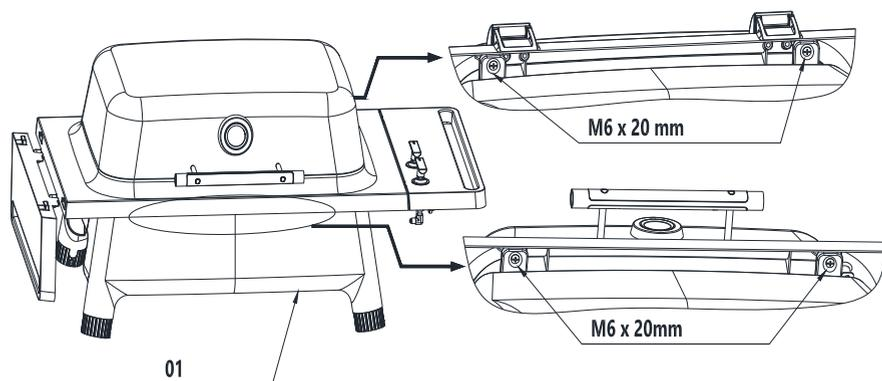
For at adskille grill/låg fra stativet sættes det let på skrå så bagsiden er løftet, hvorefter begge M6x 20mm skruer fjernes. Gør så det samme med de to skruer foran. Hold grillen stabil under processen, så den ikke vælter. Gem alle skruer og spændeskiver til senere brug. Klistermærker indikerer, hvor skruerne senere skal fastgøres. Løft nu grillen med låget af og stil den på jorden.
